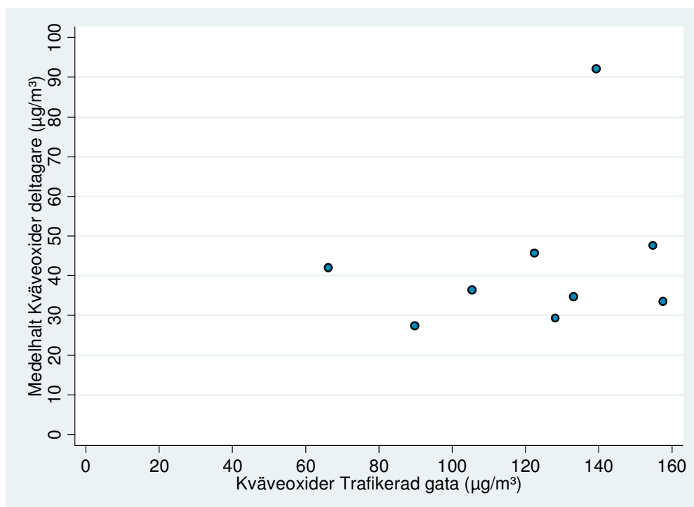
Figur 19b: Diagrammet visar korrelationen mellan medelvärdet för den personliga exponeringen för kväveoxider (n=2-8) per mätvecka och halterna av kväveoxider vid trafikerad gata motsvarande mätveckor (n=9). Det fanns inget signifikant samband mellan halterna.
